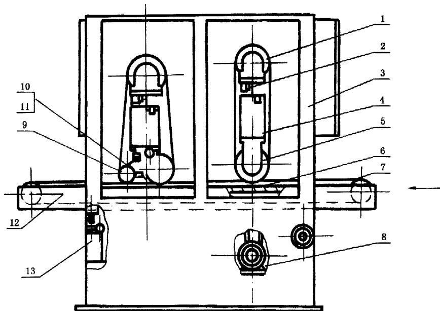
1—张紧辊及轴承座；2—砂带摆动装置；3—机架；4—悬臂梁；5—接触辊及轴承座；6—工作台面；
