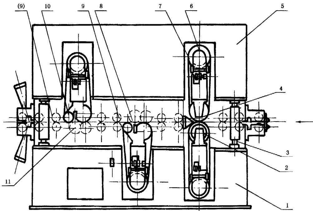
1—下机架；2—下接触辊及轴承座；3—升降机构；4—上接触辊及轴承座；5—上机架；6—张紧辊及轴承座；
